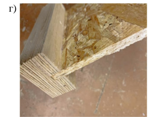
Рисунок 2. а) Паз в поясе LVL; б) Нанесение клея в паз; в) Формовочный столик; г) Выступающий клей от спрессовывания;
